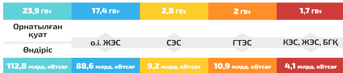
7-сурет. Электр энергияның өндіру/тұтыну құрылымы және Қазақстан БЭЖ электр станциясының белгіленген/қолжетімді қуаттары
